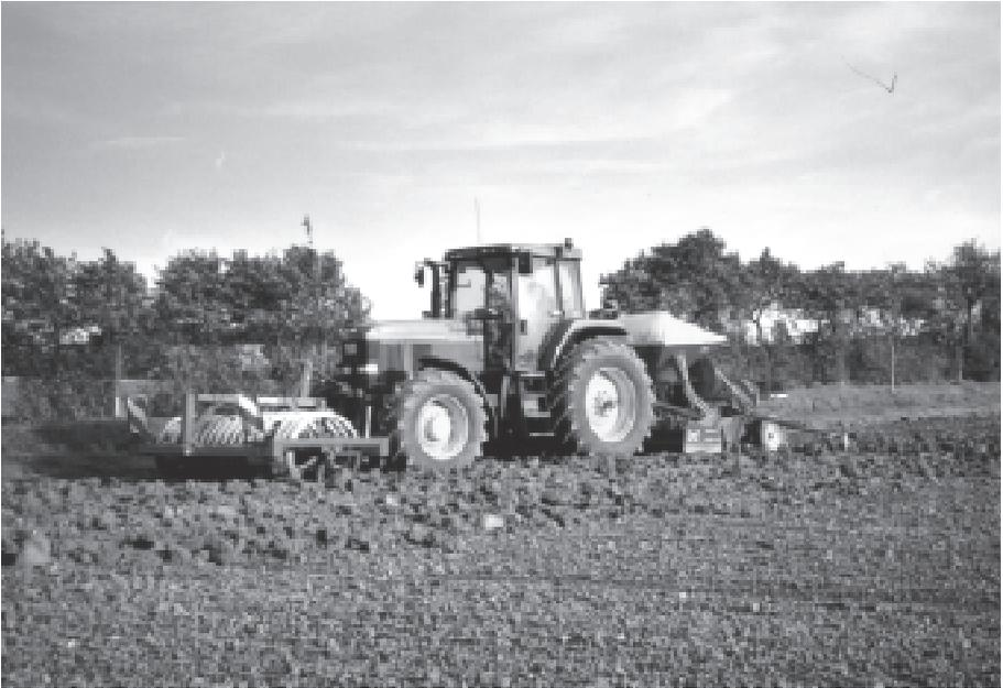
*Eine moderne Saatkombination im Besitz von Michael Meyer. Gezogen von einem 150 PS Traktor. Vorn der Packer, der die größten Erdteile (Kluten) zerkleinert, hinten die zapfwellenangetriebene Kreiselegge und die pneumatische über den Luftkessel betätigte vollautomatische Drillmaschine.*
